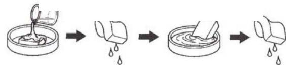
Abb. 24: Luftfilter reinigen
