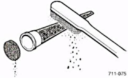
Abb. 45: Schall-dämpfer-Filter und Funkenschutz reinigen
