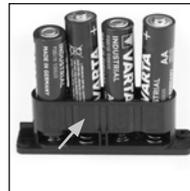
Schieben Sie den Deckel samt Batterien wieder in die Schließelektronik und schrauben Sie sie fest.
