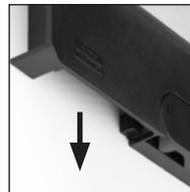
Entfernen Sie die alten Batterien und entsorgen Sie sie gemäß den Entsorgungshinweisen. Ersetzen Sie die Batterien durch vier neue 1,5 V AA Mignon-Batterien und gemäß der korrekten Polung. Hierzu sind Abbildungen auf der Batteriehalterung dargestellt. Bitte benutzen Sie Markenbatterien und keine Akkus.
