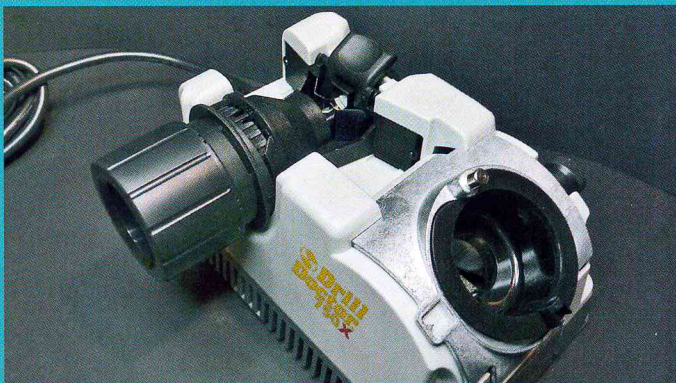
Das Ausrichten des Bohrers im Futter geschieht in einer separaten Aufnahme seitlich am Gerät
